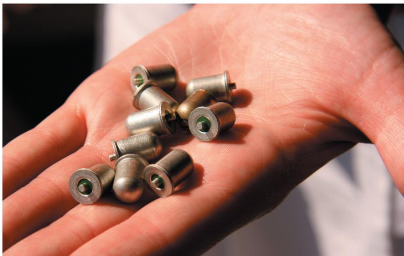
ÉlimiMercure est un programme national de retrait, de collecte et de gestion des interrupteurs d'éclairage d'appoint et des modules de capteur des systèmes de freinage antiblocage (ABS) des véhicules en fin de cycle de vie utile.
